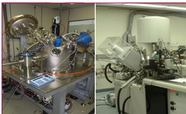
شکل ۱۵: تصویر از روبرو و نمای جانبی دستگاه XPS [۱۴].
