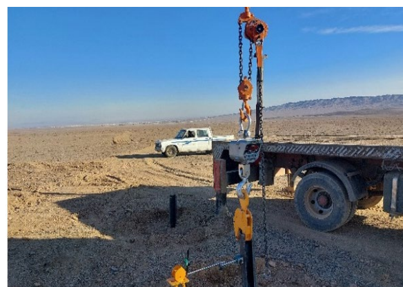
شکل (۱): نمونه‌هایی از چیدمان‌های غیراستاندارد در آزمایش بارگذاری کششی؛ استفاده از بوم غیرصلب ماشین‌آلات سنگین مانند جرثقیل و بیل مکانیکی که منجر به عدم کنترل نرخ بارگذاری و ایجاد خطا در اندازه‌گیری جابه‌جایی‌ها می‌شود.
