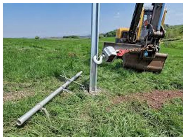
شکل (۴): نمونه‌های غیراستاندارد چیدمان آزمایش بار جانبی و عدم انطباق با استاندارد ASTM D3966.
