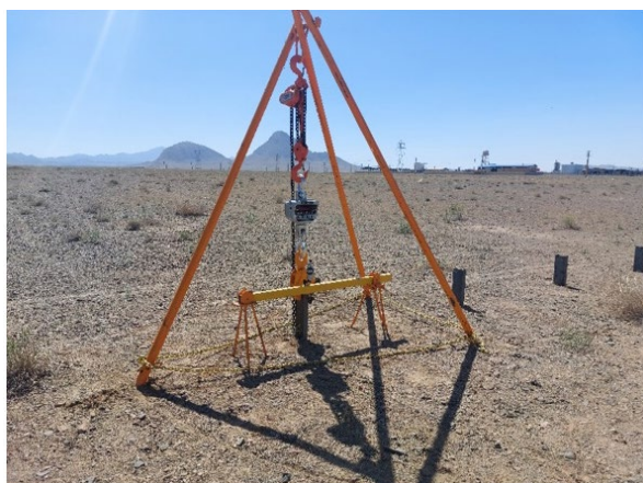
شکل (۲): چیدمان صحیح و منطبق با الزامات آزمایش بارگذاری کششی با استفاده از سه پایه صلب فلزی، براساس استاندارد ASTM D3689.
