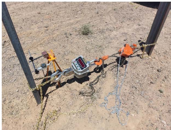
شکل (۳): نمونه‌های استاندارد چیدمان آزمایش بار جانبی مطابق با استاندارد ASTM D3966.
