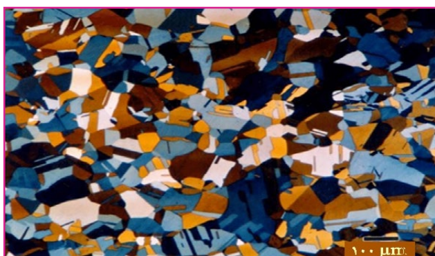
شکل (۱۲): ریزساختار نور پلاریزه آلیاژ آهن و نیکل با براها اسید سولفامیکی اچ شده [۱].
