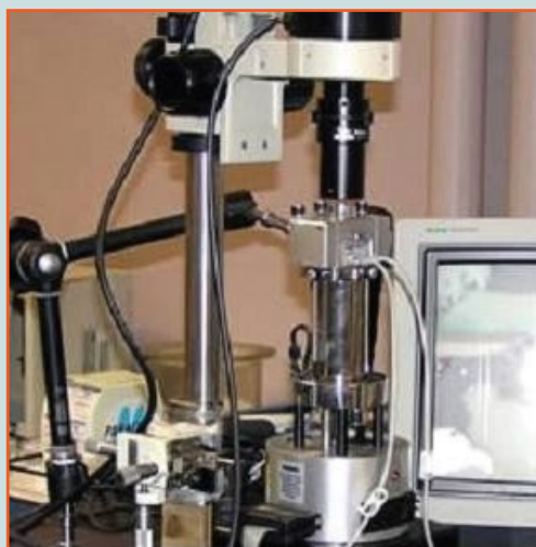
شکل (۱): میکروسکوپ نیروی اتمی برای اندازه‌گیری کشسانی [۴].
