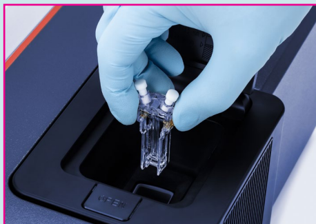
شکل (۱): نمایی از چگونگی قرار گرفتن نمونه در دستگاه DLS.
