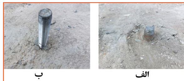
شکل (۶): (الف): نمایشی از گسیختگی ایجاد شده در فولاد و (ب): نمای فولاد سالم با همان شرایط کاشت و ترک ایجاد شده در بتن.
