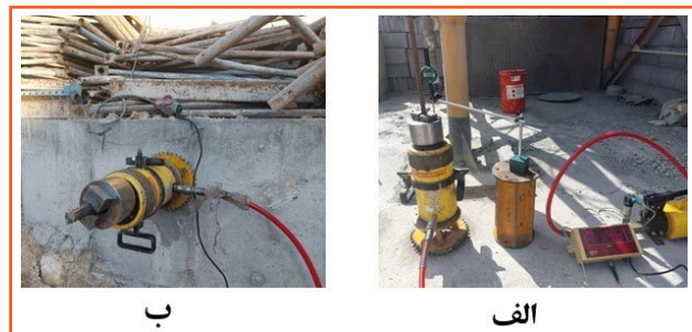
شکل (۱): نمایی از آزمایش بیرون کشی آرماتور در محل با استفاده از سیستم هیدرولیک. (الف): کاشت عمودی و (ب): کاشت افقی.
